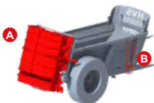
(A) Ośłona z drzwiami 2-skrzydłowymi (B) Drabinka dająca wgląd do wnętrza skrzyni
